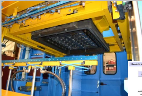
90° drehbares Werkzeugoberteil für Inspektion und Reinigung
