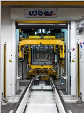
90° drehbares Werkzeugoberteil für Inspektion und Reinigung
