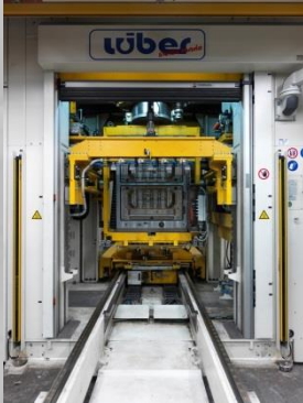
90° drehbares Werkzeugoberteil für Inspektion und Reinigung
